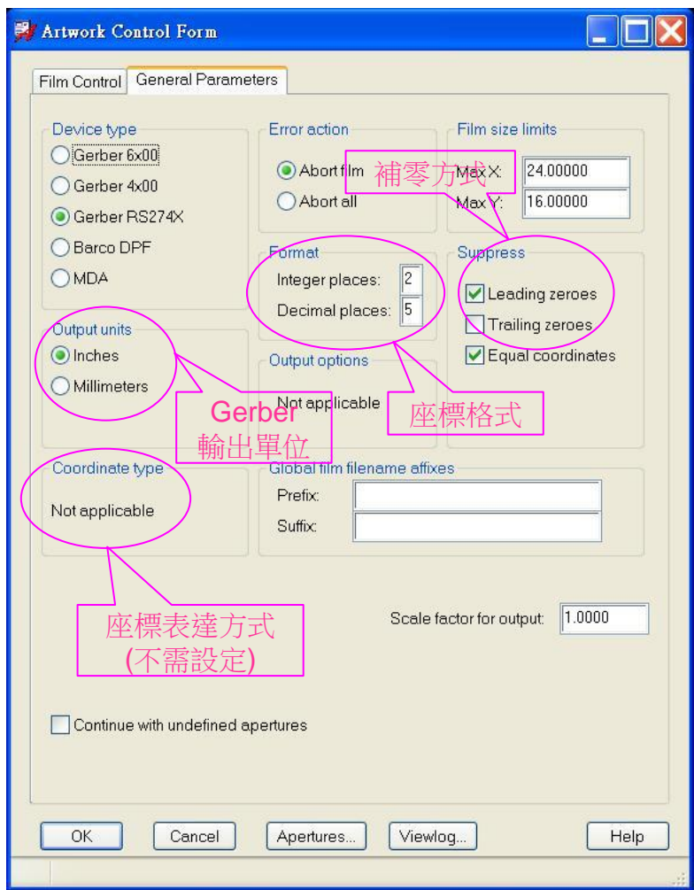
圖 2.2-1 Allegro 輸出 Gerber data 時之相關參數設定
