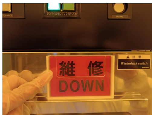
DOWN 狀況牌： 設備不可用，需通知工程師。 / DOWN status card: tool unavailable; notify engineer.
