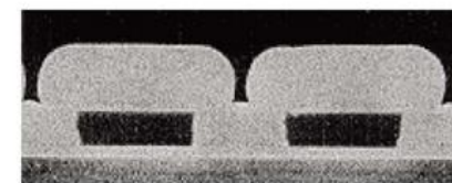
圖 10.23 TEOS 與矽烷形成的二氧化矽階梯覆蓋性。( 應用材料公司提供 )
